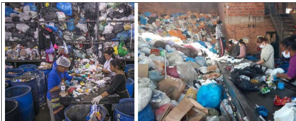
Figura 40. Centrais de triagem semiautomatizadas.
